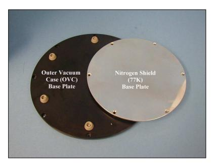
**Photo 1.3.** Cryostat base-plates
