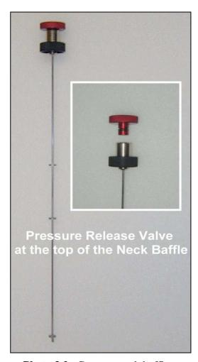
Photo 3.2. Cryostat neck baffle
